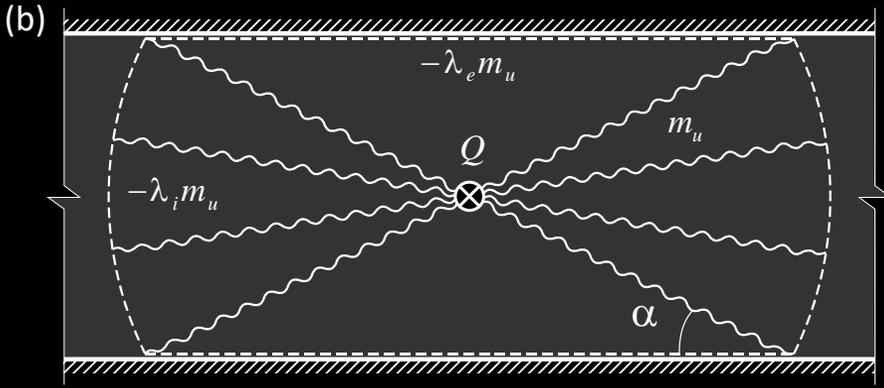
Traglast für Mechanismen gemäss Bild (a) und (b) für verschiedene Werte von  $\lambda_i$  und  $\lambda_e$
