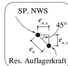
$$V_d : \text{Stützenkraft abzüglich Last auf Nachweisfläche: } V_d = V_{d,st} - q_d \cdot A_{NWS} = 1243 \text{ kN} \quad 4.3.6.2.6$$
