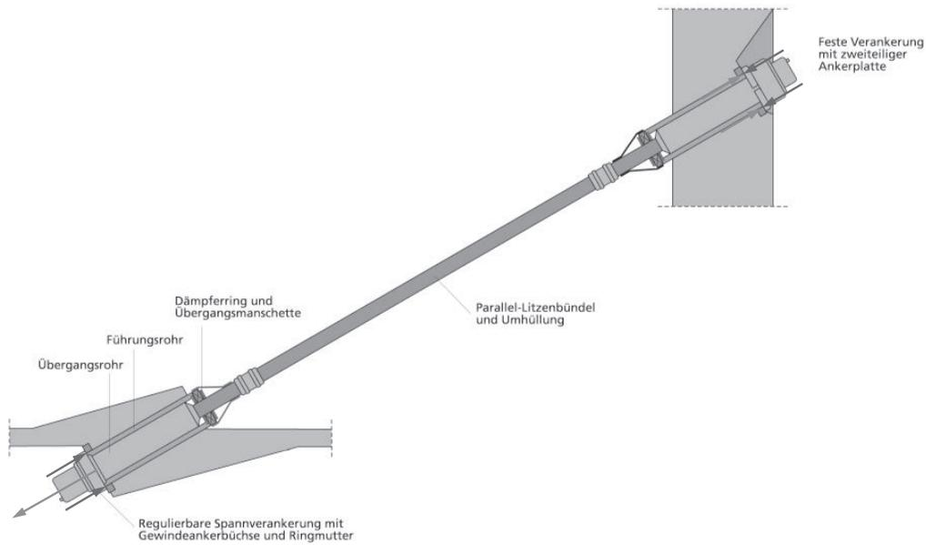
Schrägkabel kommen insbesondere in Schrägseilbrücken zum Einsatz.
