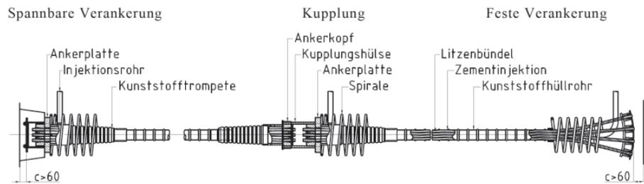
Die Abbildung zeigt ein Beispiel eines Spannsystems resp. die einzelnen Komponenten.
