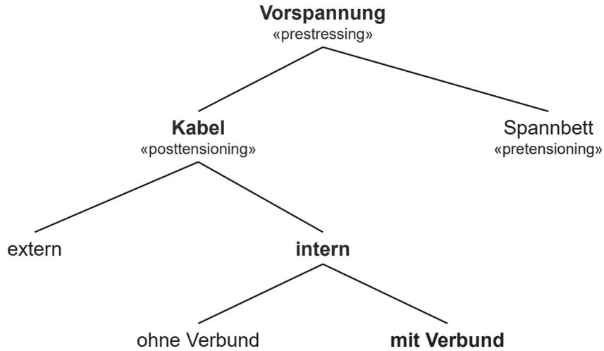
Wie erwähnt liegt der Schwerpunkt der Vorlesung auf dem am häufigsten eingesetzten Fall: Nach dem Erhärten des Betons aufgebrachte, interne Vorspannung mit Verbund (*internal, bonded posttensioning*). Diese ist – sofern nicht anders vermerkt – Gegenstand aller folgenden Folien.
