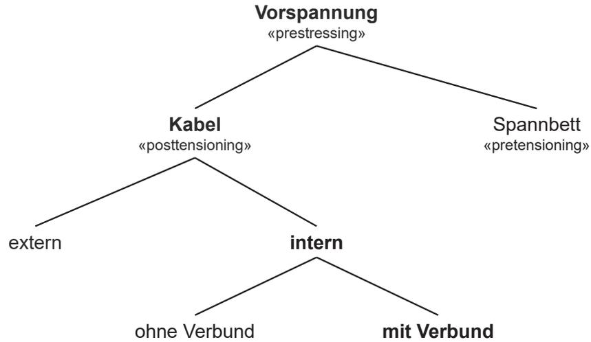
Externe Vorspannung kommt vor allem im Brückenbau zum Einsatz. Neben der Längsvorspannung von Brückenträgern sind externe Spannkabel insbesondere auch als Zugglieder von Schrägseilbrücken verbreitet.
