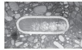
NB. Spannstahl liegt **nicht** zentrisch im Hüllrohr, sondern auf der Krümmungsinneseite.
