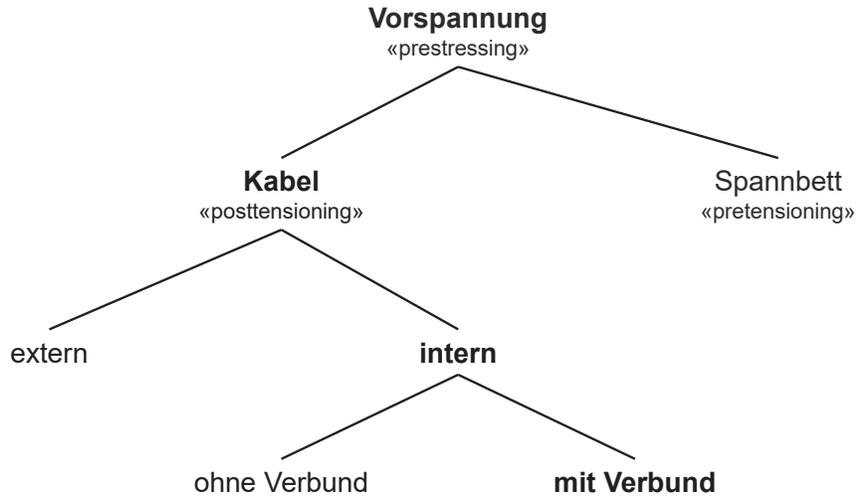
In der Vorfabrikation kommt häufig eine Spannbettvorspannung zum Einsatz.
