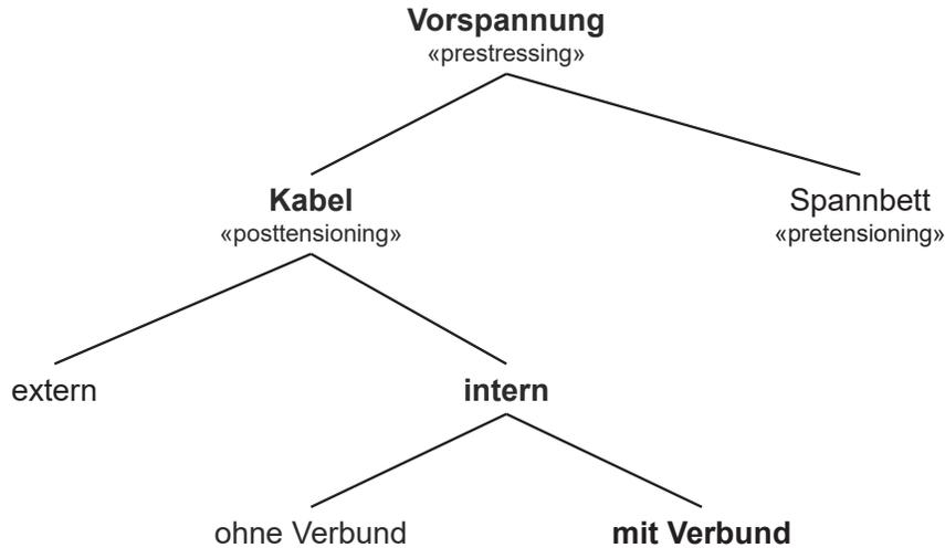
Meist werden Spannglieder mit nachträglichem Verbund eingesetzt. Bei diesen wird das Hüllrohr nach dem Vorspannen ausinjiziert. In Ausnahmefällen kommt eine Vorspannung ohne Verbund zum Einsatz.
