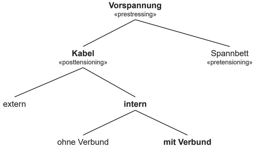
Die Vorspannung («prestressing») kann nach dem Zeitpunkt des Spannens (vor dem Betonieren = «Spannbettvorspannung» = «pretensioning», nach dem Betonieren = «Kabelvorspannung» = «posttensioning»), nach der Lage der Spannglieder (innerhalb des Querschnitts = «internal», ausserhalb des Querschnitts = «external») und nach dem vorhandenen Verbund zwischen Beton und Bewehrung (mit Verbund = «bonded», ohne Verbund = «unbonded») eingeteilt werden.
