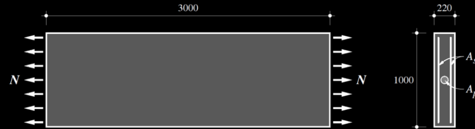
Bild 1.1 – Konzept der Zugversuche, [mm].
