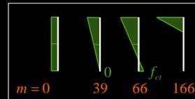
Im Beispiel wurde bei der Ermittlung des Momenten-Krümmungs-Diagramms ein linear elastisches Verhalten des Betons vorausgesetzt. Für höhere Beanspruchungen wird die wirkliche Steifigkeit damit überschätzt.
