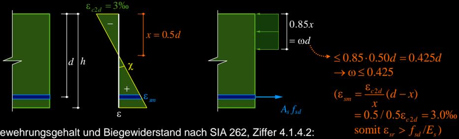
Maximaler Bewehrungsgehalt und Biege­widerstand nach SIA 262, Ziffer 4.1.4.2: (für vorwiegend auf Biegung beanspruchte Bauteile)
