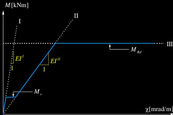
Mit den elastischen Biegesteifigkeiten im ungerissenen und gerissenen Zustand sowie dem Biegezugwiderstand kann die komplette Momenten-Krümmungs-Beziehung eines Querschnitts aufgezeichnet werden.
