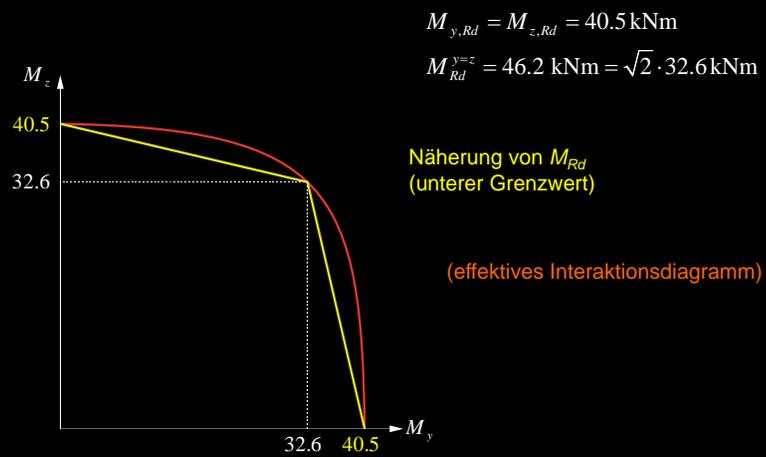
Interaktionsdiagramm des Beispielquerschnitts.
