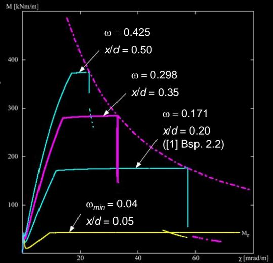
Das Diagramm zeigt Momenten-Krümmungsverläufe für typische Bewehrungsgehalte. Das Rotationsvermögen (plastische Rotation = Integral der plastischen Krümmungen über die Länge des plastischen Gelenks) ist bei kleinen Bewehrungsgehalten ebenfalls entsprechend viel grösser als bei grossen Bewehrungsgehalten.
