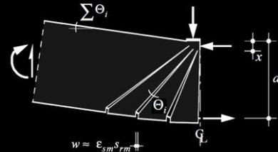
In der Folie sind die Beziehungen für das Rotationsvermögen für die Brucharten (i) Reissen der Bewehrung, oben und (ii) Betonbruch, unten angegeben. Massgebend ist der jeweils kleinere Wert.
