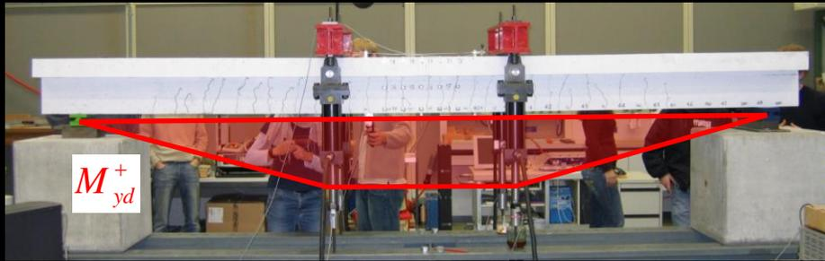
Angestrebte Bruchart (duktil): Betonbruch während Stahlfließens:
