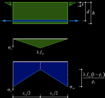
Krümmungsreduktion ( $\rho_t$  in Formel unten rechts auf Folie 59 rückeringesetzt):
