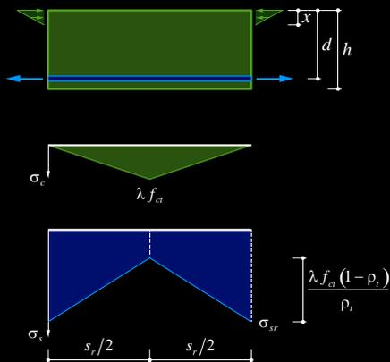
**Zugversteifung** bei Biegebeanspruchung analog zu Verhalten unter reinem Zug:
