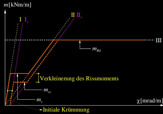
Darstellung des Einflusses des Schwindens in Zustand I und II im Momenten-Krümmungs-Diagramm.
