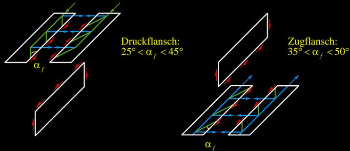
Bei Plattenbalken ist die Tragwirkung in Querrichtung zu berücksichtigen. Ein wichtiger Aspekt ist hier die Ausbreitung der Gurtkräfte, deren Variation durch die im Steg wirksame Querkraft verursacht wird. Näheres dazu siehe Fachwerkmodelle im Kapitel 3.4 Querkraft).
