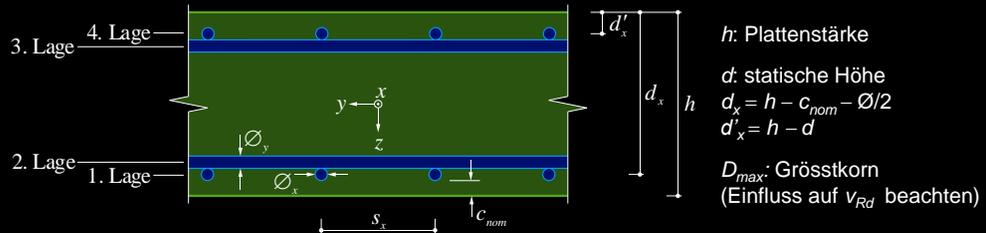
$\varnothing$  Stabdurchmesser (Querschnittstabelle): (6,8), 10, 12, ..., 20, 22, 26, 30, (34, 40) mm
