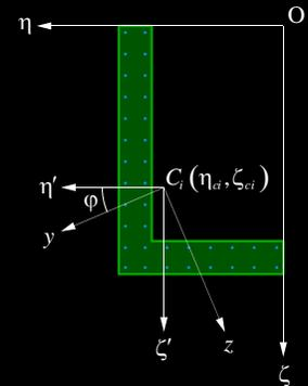
Das elastische Querschnittsverhalten kann mit der Theorie der aus linear elastischen Werkstoffen aufgebauten Verbundquerschnitte untersucht werden (siehe Vorlesungen Baustatik). Im Betonbau wird dabei der Beton als Referenzmaterial (Wertigkeit 1) benützt.
