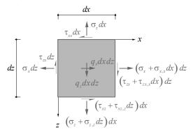
Positive Spannungen wirken an Elementen mit positiver äusserer Normalenrichtung in positiver Achsenrichtung Positive Membrankräfte entsprechen positiven Spannungen
