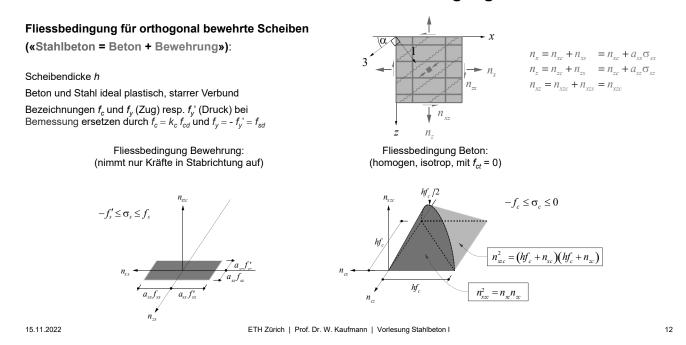
Analog zur Konstruktion von Interaktionsdiagrammen für Biegung und Normalkraft können die Fliessbedingungen orthogonal bewehrter Scheibenelemente unter Membranbeanspruchung durch eine grafische Linearkombination der aplastischen Bereiche von Beton und Bewehrung ermittelt werden.
