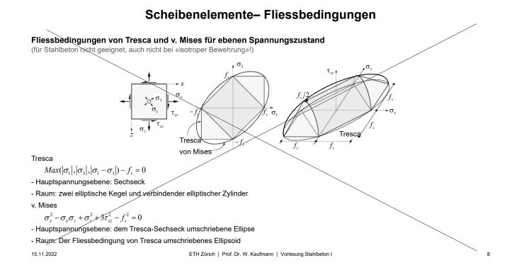
Fliessbedingungen für isotrope Materialien (Stahl: Tresca, von Mises) können nicht auf Stahlbeton angewendet werden, auch nicht für die Bemessung der Bewehrung und selbst dann nicht, wenn diese «isotrop» (gleicher Bewehrungsgehalt in beide Richtungen) ist. Die Anwendung kann auf der sicheren oder unsicheren Seite liegen.
