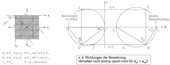
a: Hauptdruckrichtung im Beton
