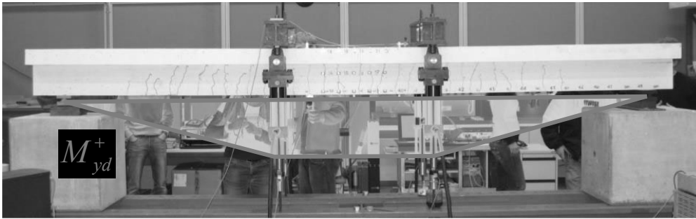
Angestrebte Bruchart (duktil): Betonbruch während Stahlfließens:
