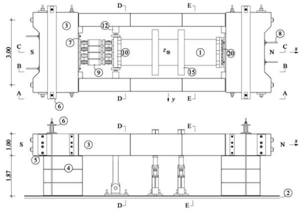
Vor kurzem wurden an der ETH Zürich Versuche an Plattenstreifen unter exzentrischem Längsdruck durchgeführt. In den Versuchen wurde das Zusammenwirken von altem und neuem Beton untersucht. Die beiden Grundversuche A “alter Beton” und N “neuer Beton” (in denen das Zusammenspiel alter-neuer Beton keine Rolle spielte) eignen sich gut zur Illustration des Verhaltens unter Normalkraft und Biegung bei relativ kleiner Exzentrizität.
