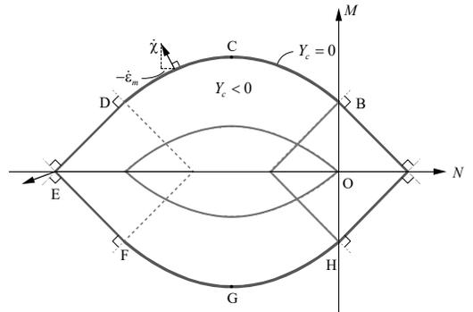
Der aplastische Bereich des Stahlbetonquerschnitts (= das  $M-N$ -Interaktionsdiagramm für starrplastisches Verhalten) kann – analog zu demjenigen der beiden Bewehrungslagen – grafisch konstruiert werden, indem der aplastische Bereich der beiden Bewehrungslagen mit seinem Ursprung entlang der Grenze des aplastischen Bereichs des Betons verschoben wird ... oder umgekehrt (grafische Linearkombination).
