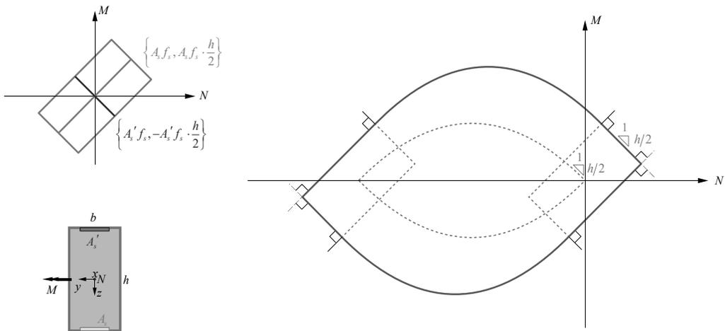
Bei nicht symmetrischer Bewehrung liegen die Eckpunkte des aplastischen Bereichs der Bewehrung nicht mehr auf den Koordinatenachsen. Der Einfluss der nicht symmetrischen Bewehrung auf den aplastischen Bereich des Stahlbetonquerschnitts (= auf das  $M-N$ -Interaktionsdiagramm für starr-plastisches Verhalten) ist durch die grafische Konstruktion direkt ersichtlich.
