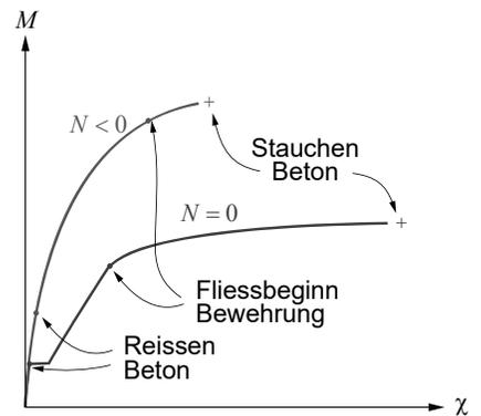
Biegung in Kombination in Normalkraft tritt in vielen Bauteilen auf.
