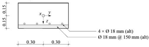
Versuchskörper N – Querschnittsgeometrie
