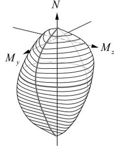
Wie einleitend bemerkt, wird der Tragwiderstand am einfachsten mittels sogenannter *Interaktionsdiagramme* untersucht. Interaktionsdiagramme für Biegung und Normalkraft können im allgemeinen Fall im Raum  $\{N, M_y, M_z\}$  dargestellt werden. Jeder Punkt  $\{N, M_y, M_z\}$ <sub>Rd</sub> eines solchen Interaktionsdiagramms entspricht einer Kombination von  $\{N, M_y, M_z\}$ , unter welcher der Tragwiderstand erreicht wird.
