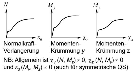
Unter der Annahme einer linearen Verteilung der Längsdehnungen («Ebenbleiben des Querschnitts») ist der Verformungszustand («Dehnungsebene») in jedem Querschnitt durch drei Verformungsgrößen («verallgemeinerte Dehnungen») eindeutig definiert. Üblicherweise verwendet man als verallgemeinerte Dehnungen die Dehnung der Schwerachse  $\varepsilon_0$  und die Krümmungen  $\chi_y$  und  $\chi_z$ .
