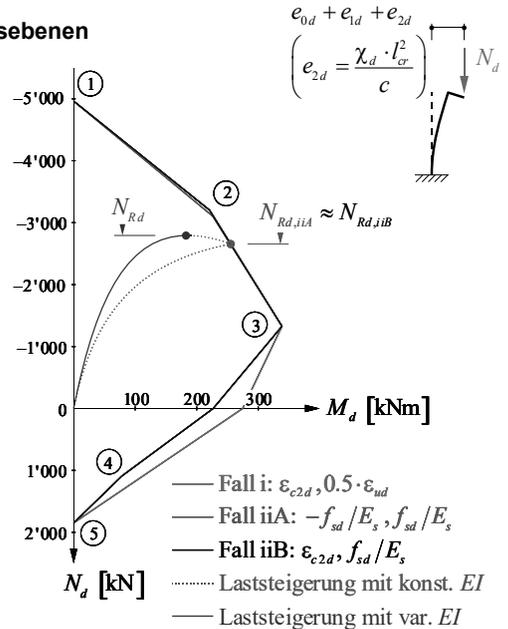
Die Abbildung illustriert schematisch das Verhalten eines schlanken Druckglieds unter zunehmender Normalkraft. Die Biegebeanspruchung im massgebenden Querschnitt nimmt infolge der Verformungen zweiter Ordnung mit der Normalkraft überproportional zu.
