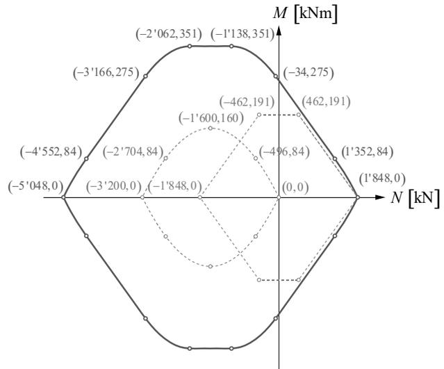
Die Ermittlung des starr-ideal plastischen Interaktionsdiagramms erfolgt, indem die Widerstände von Beton und Bewehrung separat ermittelt und anschliessend summiert werden. Dies kann wiederum grafisch erfolgen. Die sich auf dem Umfang abzeichnenden Punkte werden numerisch ermittelt, indem die Normalkräfte und Biegemomente in Beton und Bewehrung für übereinstimmende Lagen der neutralen Achse summiert werden.
