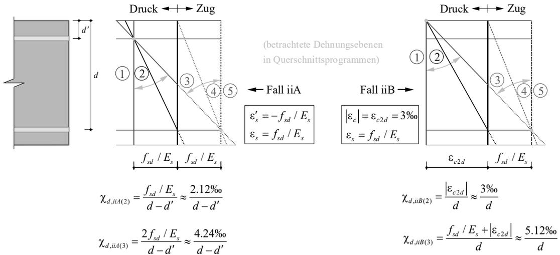
Die Abbildung zeigt, dass die Krümmung im Bruchzustand bei Verwendung der strengeren Dehnungsbegrenzungen Fall iiA kleiner ist als im Fall iiB für Dehnungsebene (2) falls  $d' < 0.29d$ , resp. für Dehnungsebene (3) falls  $d' < 0.17d$ .
