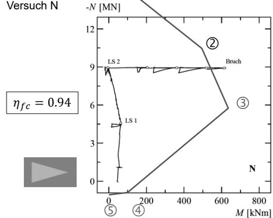
Die Folie zeigt die M-N-Interaktionsdiagramme beider Querschnitte, zusammen mit den Versuchskurven.
