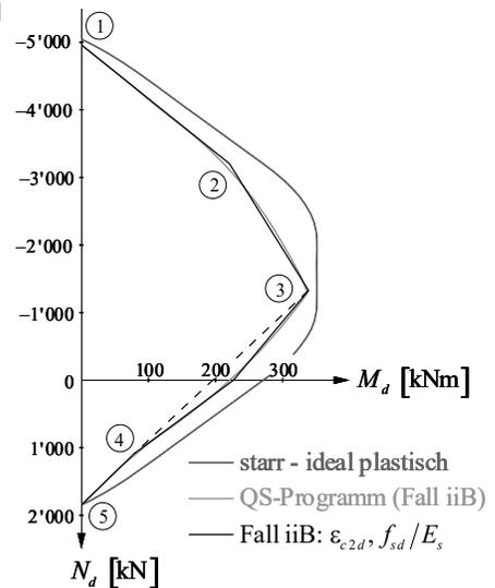
Der Vergleich mit dem auf Seite 21 ermittelten Interaktionsdiagramm für starr-ideal plastisches Verhalten zeigt, dass vor allem im Bereich grosser Biegemomente in Kombination mit Normalkraft grössere Unterschiede bestehen. Ein Teil der Unterschiede rührt auch daher, dass im starr-ideal plastischen Fall der Bruttoquerschnitt des Betons ohne Abzug der Bewehrungsfläche betrachtet wurde.
