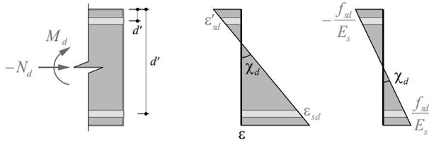
Auf der sicheren Seite liegend darf vereinfachend mit  $\varepsilon_{sd} = -\varepsilon'_{sd} = f_{sd} / E_s$  gerechnet werden. Für genauere Berechnungen kann die Krümmung entsprechend der Bruchkrümmung im massgebenden Querschnitt abgemindert werden (Iteration).
