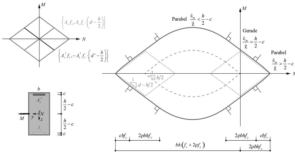
Weist die Bewehrung eine Überdeckung auf, ist die Steigung des aplastischen Bereichs der Bewehrung nicht mehr gleich gross wie diejenige des Betons im Ursprung, sondern etwas kleiner (da die äusserste Faser des Betonquerschnitts jetzt einen grösseren Hebelarm aufweist als die Bewehrung).
