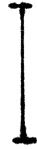
Stäbe mit aufge= stauchten oder auf= geschweissten Köpfen, evtl. auf Flachstahl aufgeschweisst → Dübelleisten
