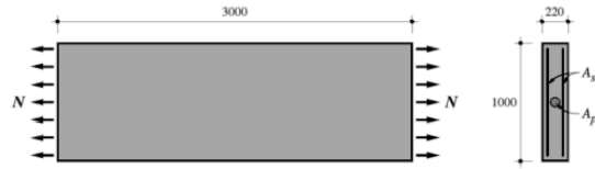
Bild 1.1 – Konzept der Zugversuche, [mm].
